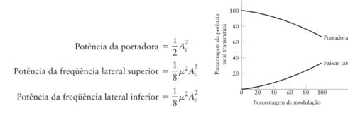
Ainda é afirmado pelos mesmos autores que a modulação em amplitude (AM) que a transmissão da onda portadora representa um desperdício de potência, já que mensagem a ser transmitida é completamente independente do sinal da portadora. Sendo assim, suprimir a portadora salva potência por meio da supressão da portada (AM-DSB/SC), diminui a potência necessária, porém a largura de banda se mantém a da AM e não oferece vantagem nesse quesito.
